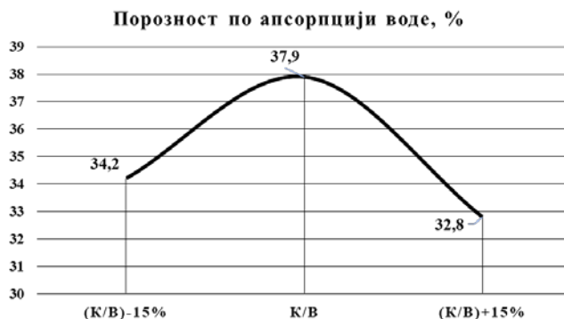
Слика 2. Зависност физичких и механичких карактеристика од количине везива.
