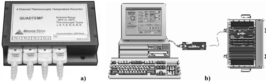
Slika 5.7. Dataloger: a) dataloger sa 4 ulazna kanala za priključivanje termoelemenata, b) dataloger priključen na računar preko telefonske veze i serijskog interfejsa
