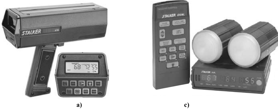
Slika 16.25. Radari za merenje brzine vozila u sabračaju: a) standradni radar, b) dualni radar sa detekcijom smera
