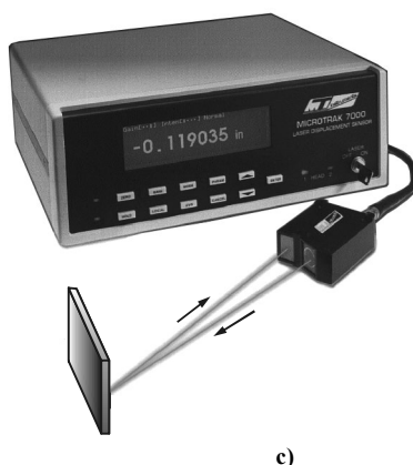
Slika 15.21. Senzor sa optičkim vlaknom i refleksijom sa površine objekta: a) princip rada, b) statička karakteristika, c) izgled senzora debljine trakastih materijala
