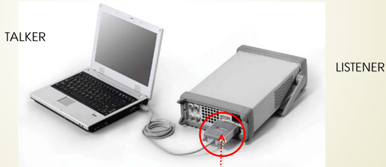
Minimalna konfiguracija IEEE 488 interfejsa (u GPIB žargonu TALKER-a i LISTENER-a putem USB-GPIB konvertora)
