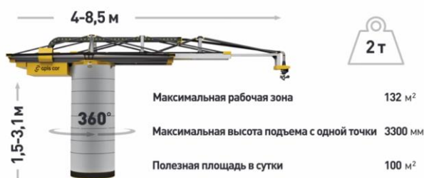
Рисунок 1. Характеристики строительного 3D-принтера Apis Cor 7R.
