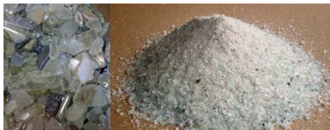
Slika 4. Grubo drobljeno staklo (levo) i naknadno usitnjeno staklo granulacije 0/4 mm (desno).
