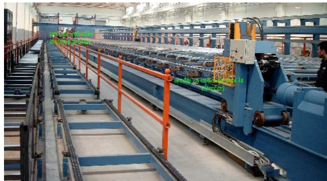
Slika 3. Snimak linije za istiskivanje profila od Al-legura.
