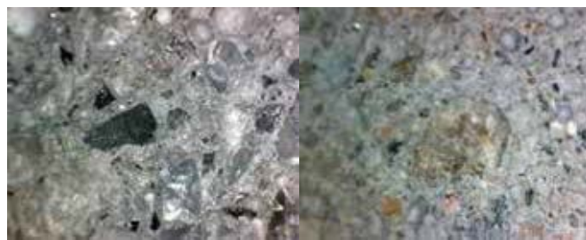
Slika 5. Lom uzorka: uzorak sa 100% stakla (levo) i referentni uzorak sa 100% agregata (desno).
