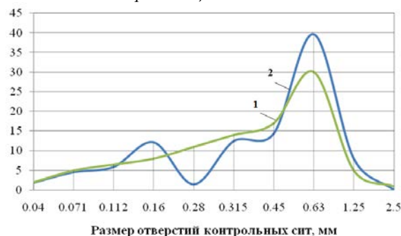
Рисунок 2. Гранулометрический состав полидисперсного заполнителя: 1 – вспученный перлитовый песок; 2 – полидисперсный заполнитель на основе вспученного перлитового песка и перлитовой пыли.
