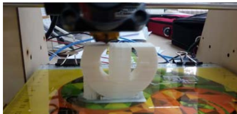
Slika 7. Tok izrade cilindričnog kliznog ležaja sa nosećom strukturom
