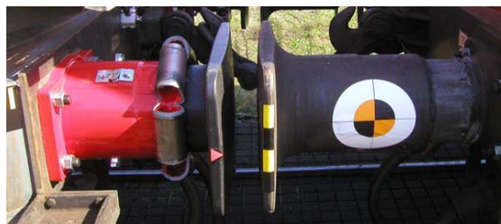
Slika 11. Odbojnik sa delom za plastičnu deformaciju u deformisanom stanju [14]
