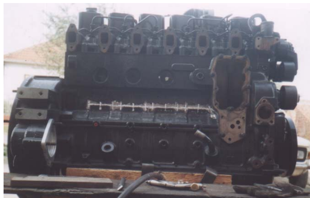
Slika 9. Reparatura napuklog bloka motora bez demontaže
