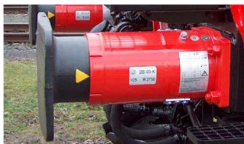
Slika 10. Odbojnik sa delom za plastičnu deformaciju u nedeformisanom stanju [14]
