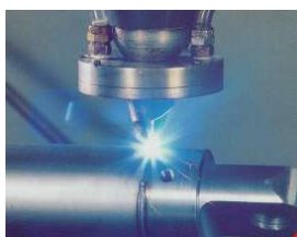
Slika 3. Lasersko zavarivanje cilindričnih delova
