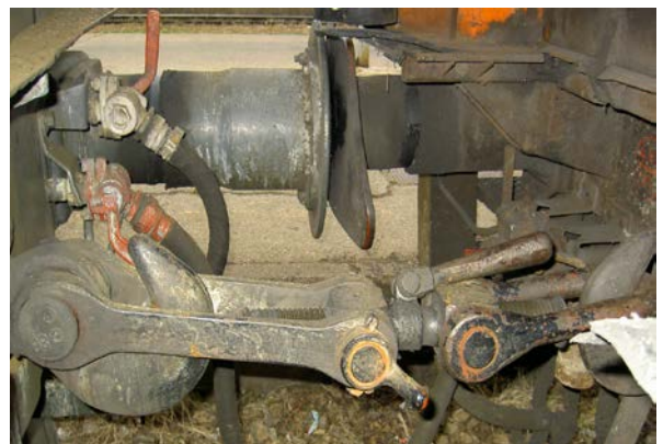
Slika 1. Odbojna i vučna oprema železničkih vozila
