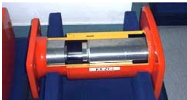
Slika 7. Odbojnik sa hidrostatički sabijenim elastomerom [10,11]
