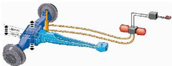
Slika 7. New Holland 'Terraglide' sistem elasti nog oslanjanja na prednjoj osovini
