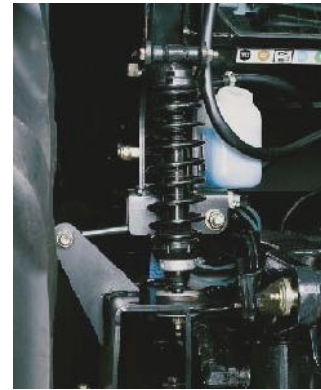
Slika 5. New Holland 'Comfort Ride' kabinski sistem elasti nog oslanjanja- detalj [5].
