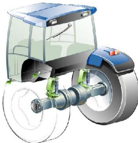
Slika 4. New Holland 'Comfort Ride' kabinski sistem elasti nog oslanjanja [5].
