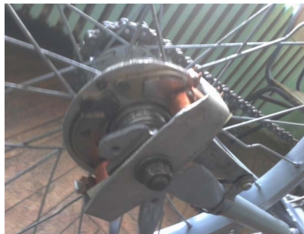
Slika 3. Praktična realizacija sa tri magneti i dva kalema.
