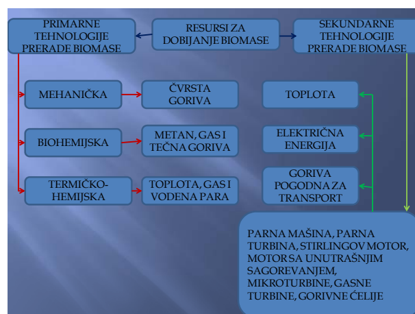
Slika 2. Šematski prikaz primarne i sekundarne tehnologije prerade biomase.
