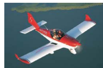
Slika 12. [10] AT serija aviona, ceo napravljen od metala, konstruisan od razvojne površi.
